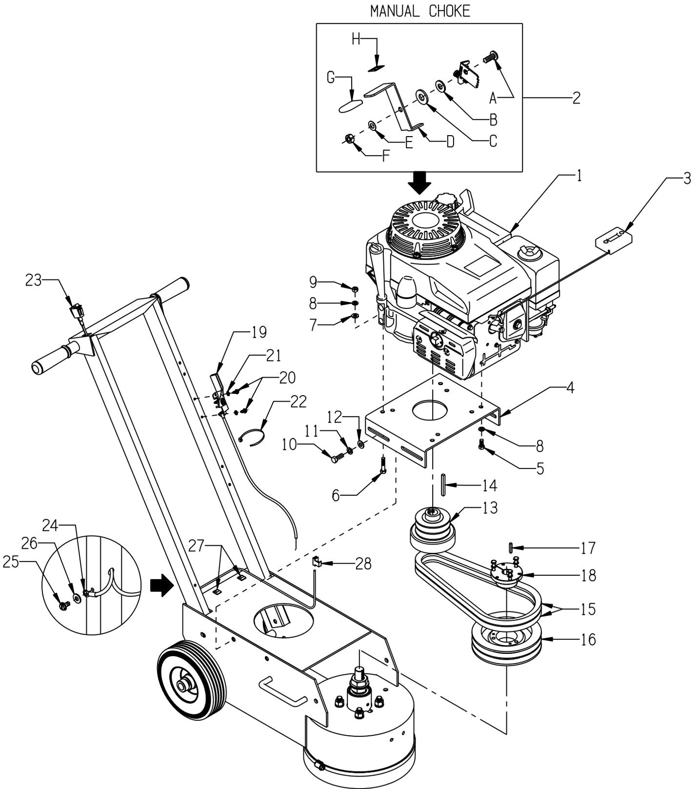
**PARTS LISTING - ILLUSTRATION 8: GASOLINE ENGINE & BELT DRIVE GROUPING**
